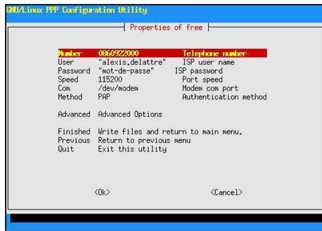
FIGURE 17.2 – pppconfig : propriétés de la connexion
