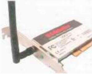
En anglais *wireless adapters* ou *network interface controller*, noté NIC. Il s'agit d'une carte réseau à la norme 802.11 permettant à une machine de se connecter à un réseau sans fil. Les adaptateurs WiFi sont disponibles dans de nombreux formats (carte PCI, carte PCMCIA, adaptateur USB, carte compactflash, ...). On appelle station tout équipement possédant une telle carte. A noter que les composants Wi-Fi deviennent des standards sur les portables (label Centrino d'Intel).
