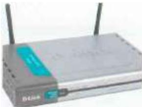
Notés AP pour *Access point*, parfois appelés bornes sans fil, permettant de donner un accès au réseau filaire (auquel il est raccordé) aux différentes stations avoisinantes équipées de cartes WiFi. Cette sorte de hub est l'élément nécessaire pour déployer un réseau centralisé en mode infrastructure. Certains modèles proposent des fonctions de modem ADSL et comprennent plus ou moins de fonctions comme un pare-feu.
