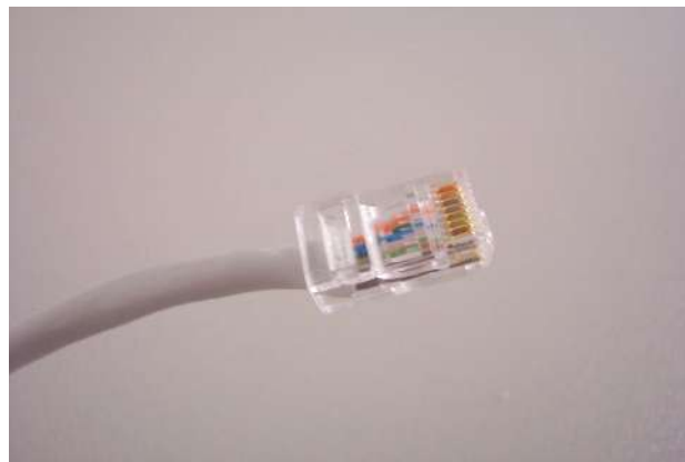
Prise RJ-45 et connecteur RJ-45
