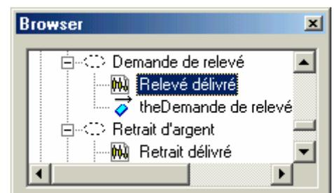
échangés entre les objets pour réaliser la fonctionnalité souhaitée. Avec l'explorateur, un diagramme de séquence (□ *Sequence Diagram*) est créé, sous une réalisation de cas d'utilisation. Les objets concernés sont des instances des classes précédemment identifiées ou spécialement créées pour cette réalisation.
