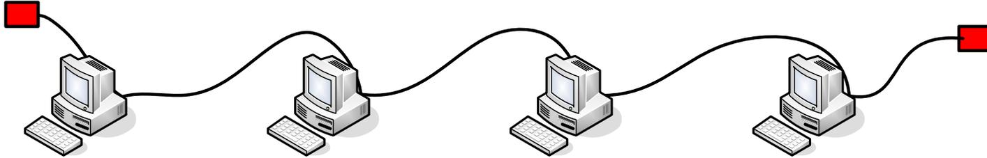
**Chacun des segments doit être terminé à chacune de ces extrémités par une résistance de terminaison de  $50 \pm 2 \Omega$ .**
