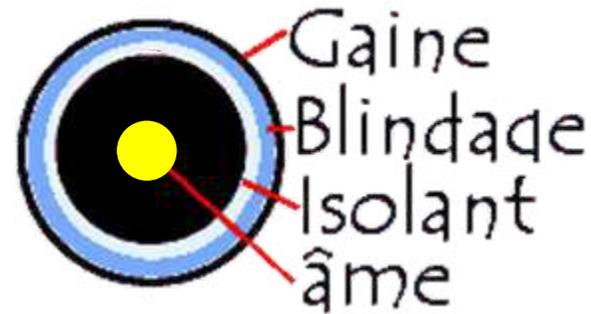
**La gaine** permet de protéger le câble de l'environnement extérieur. Elle est habituellement en caoutchouc (parfois en Chlorure de polyvinyle (PVC), éventuellement en téflon)
